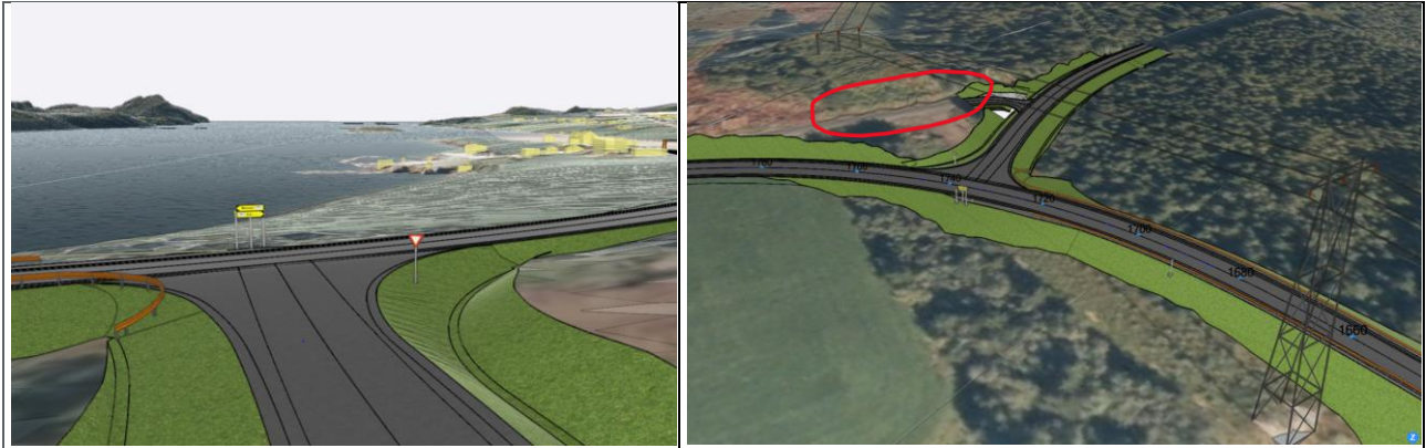
Figur 2-11 T-kryss ved Tjærraverket på Jøa. Bilde til venstre er sett ifra kommunal veg. Bilde til høyre viser krysset i perspektiv. Det ivaretas adkomst til areal avsatt til reindrift, rødt omriss. Kilde: Norconsult
