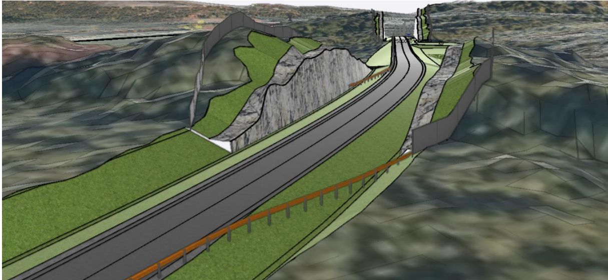
Figur 4-4 Ny veg gjennom bergskjæring med høyde opptil 8 meter, sett i retning mot nordvest. (Kilde: Norconsult).
