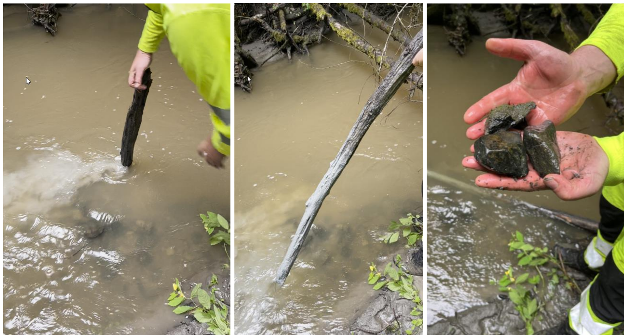
Figur 7: Et tynt gruslag med steiner over leire i bunnen av elva. Det var liten motstand mot å stikke en pinne over en meter ned i elvebunnen.
