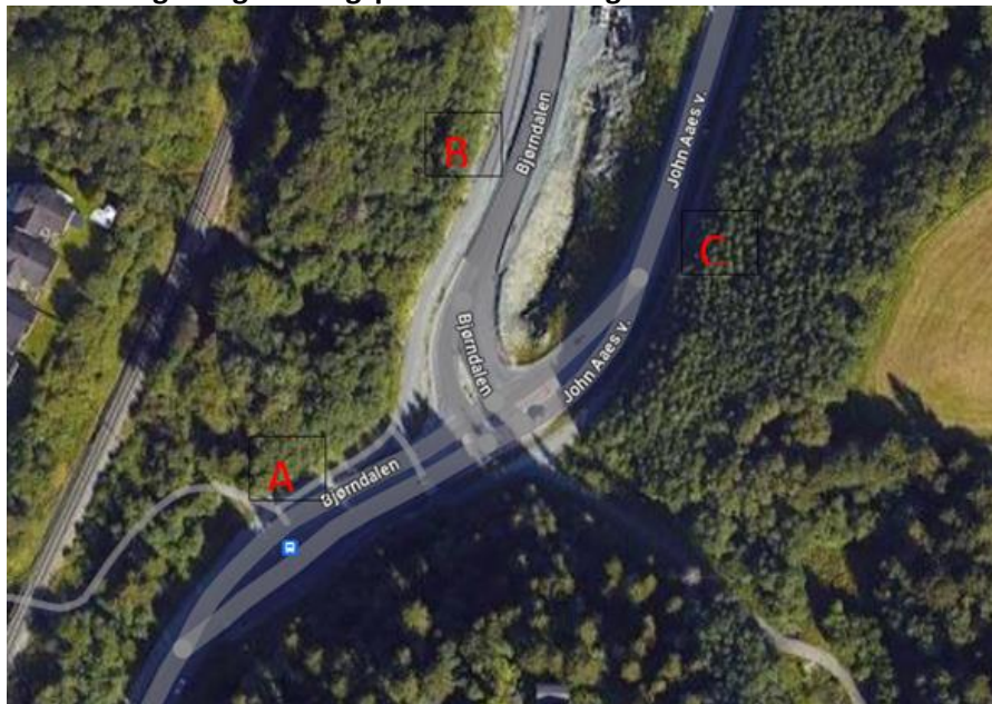
Figur 4-19: Punkter (snitt) for telling er markert med bokstavene A, B og C. Disse er å finne i tabellene nedenfor, som angir registreringer mellom disse punktene. Registreringene for A til B indikerer ferdselen gjennom Bjørndalen.
